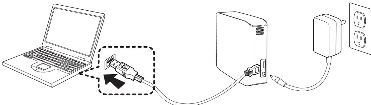
➤ Для использования модели Жесткого диска на максимальной скорости необходим ПК или устройство, поддерживающие интерфейс USB 3.0.
